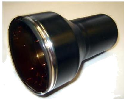
Конструктивное оформление: ФЭУ-183 ,ФЭУ-183-1 изготовлен в стеклянном баллоне с торцевым оптическим входом, с жесткими выводами. Входное окно выполнено из боросиликатного стекла С50-3 или С52-2.
