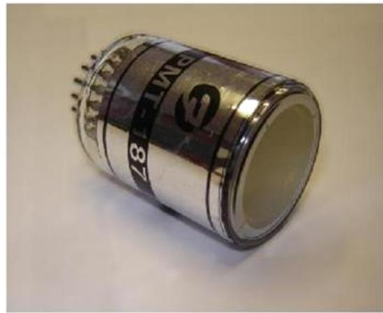
Конструктивное оформление: прибор изготавливается в стеклянном баллоне с торцевым оптическим входом, с жесткими выводами. Входное окно выполнено из боросиликатного увиолевого стекла, первый динод типа "proximity". Возможная комплектность: колодка с делителем напряжения.
