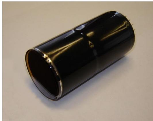
Конструктивное оформление: ФЭУ-176 изготовлен в стеклянном баллоне с торцевым оптическим входом и жесткими выводами. Входное окно выполнено из боросиликатного стекла С50-3 или С52-2.
